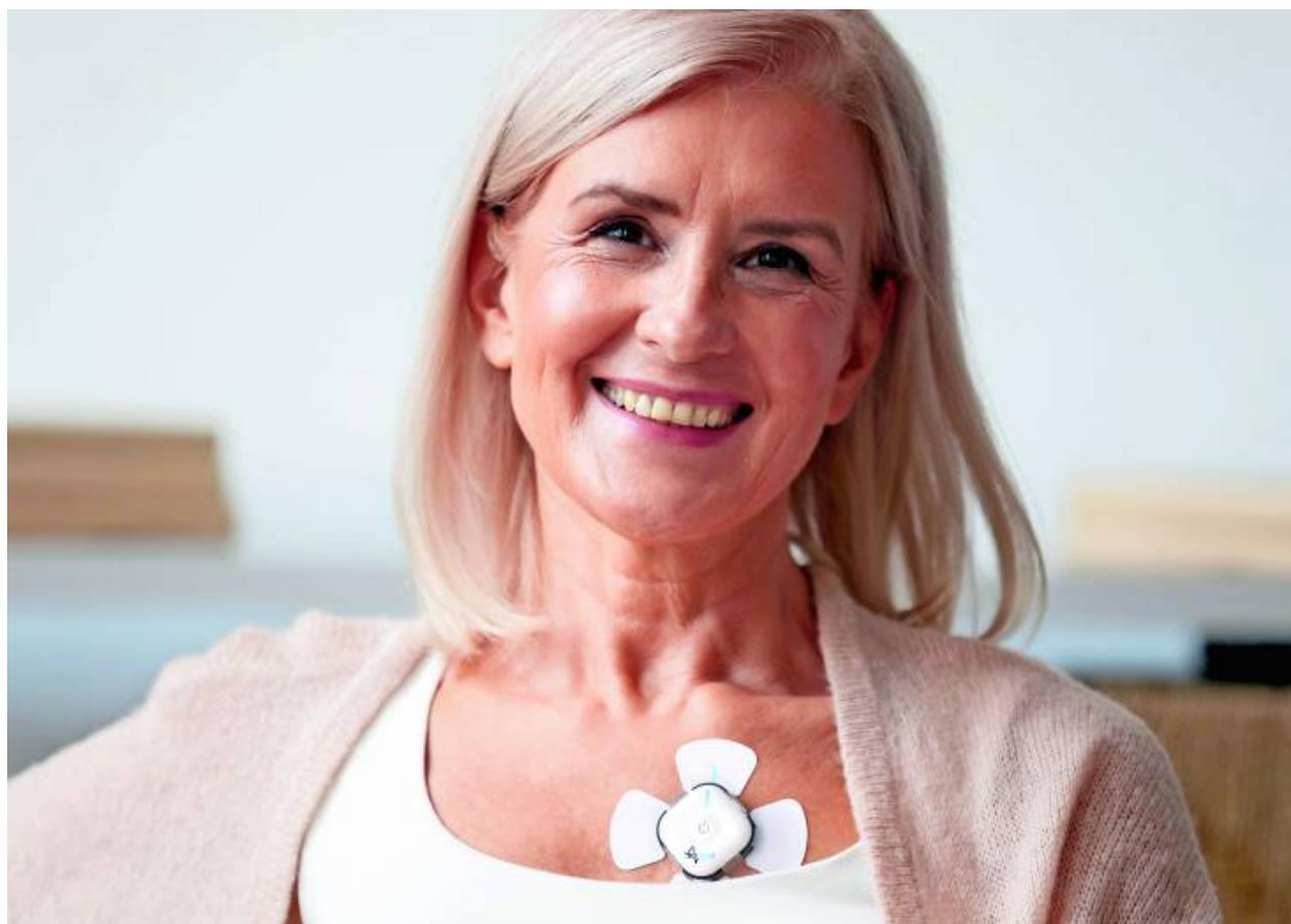
Mit einem kleinen Sensor auf der Brust, soll die Langzeitblutdruckmessung weniger kompliziert funktionieren als mit der Manschette, die sich alle 15 Minuten automatisch aufbläst.
